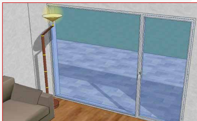
Un éclairage de type halogène à proximité du vitrage ou orienté vers le vitrage.
